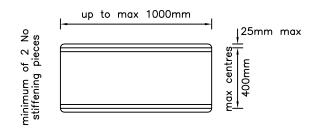
LARGE TRIANGLES OF 900mm OR GREATER USE MINIMUM OF 3 No HORIZONTAL STIFFENERS
